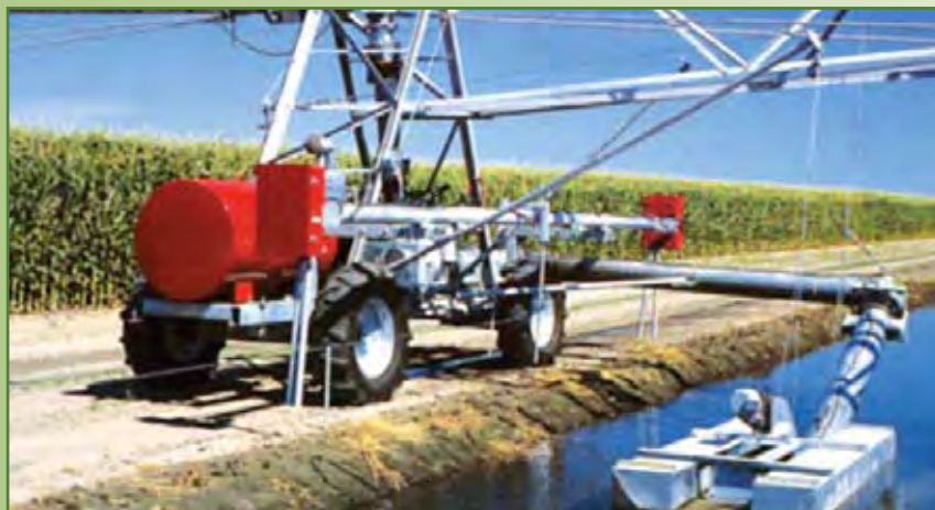
sistema di spostamento laterale con alimentazione diretta da canale
